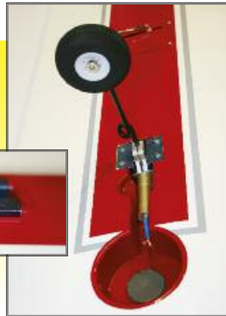
▲ Die Mechaniken des Einziehfahrwerks sollen auf die Flächen geschraubt werden. Dies ist optisch und aerodynamisch nicht besonders vorteilhaft. Beim Testmodell wurden die Fahrwerksbrettchen mit entsprechenden Vertiefungen versehen; die Mechanik schließt nun bündig ab.
