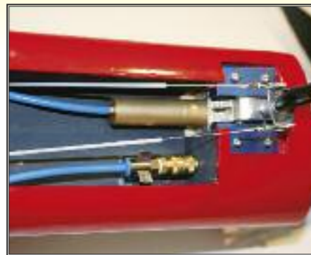
Blick in den vorderen Fahrwerksschacht. Der untere Schlauch mit Kupplung dient zum Befüllen des Lufttanks. Damit das Teil nicht im Schacht rumbaumelt, wird es nach dem Befüllen in eine kleine Federklammer gesteckt. Gut zu erkennen sind auch die hochgebogenen Enden des Steuerhebels. ▶
