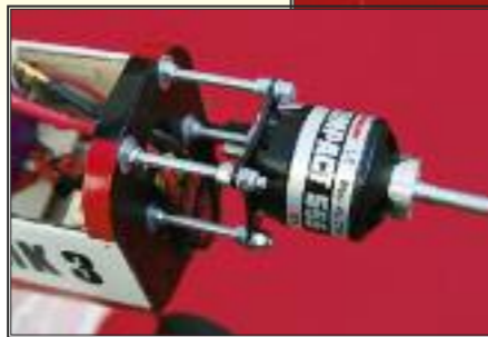
Der Motor ist auf M5-Gewindestangen fixiert. Seitenzug und Sturz lassen sich so in kurzer Zeit anpassen. Die Haube hat zur besseren Kühlung ein paar Schlitze und eine Öffnung im hinteren Bereich bekommen.
