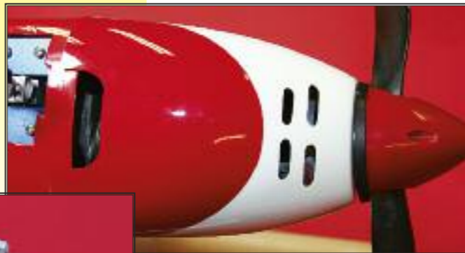
Der Motor ist auf M5-Gewindestangen fixiert. Seitenzug und Sturz lassen sich so in kurzer Zeit anpassen. Die Haube hat zur besseren Kühlung ein paar Schlitze und eine Öffnung im hinteren Bereich bekommen.
