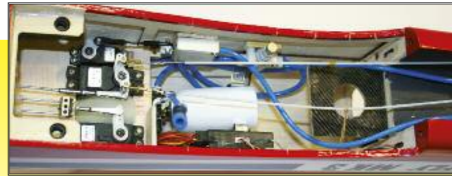
▲ Das Technikzentrum – full house. Im oberen Bildteil befindet sich das Servo für das Servoventil, daneben das Ventil sowie das Drosselrückschlagventil für das Regeln der Ein- und Ausfahrsgeschwindigkeit. Bildmitte: Der kleine Luftbehälter, gehalten durch eine Resoklammer. Unterer Bildteil: Der Spektrum-Empfänger. Gut zu erkennen sind auch die beiden Bowdenzug-Innenröhrchen sowie die Gummis, die ein Einfädeln der dünnen Steuerseile verhindern.
