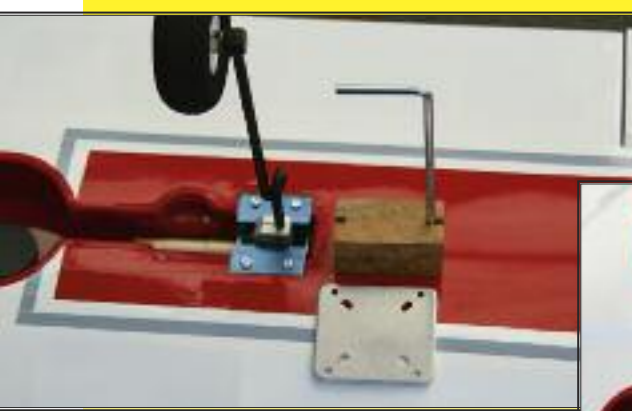
Das starre Fahrwerk wird mit einem Hartholzklott und einer Aluplatte am Flügel befestigt. Beim Einbau eines starren Fahrwerks wird der Flächenausschnitt mit einem Balsaklotz verschlossen.
