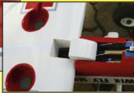
Der Motor ist auf M5-Gewindestangen fixiert. Seitenzug und Sturz lassen sich so in kurzer Zeit anpassen. Die Haube hat zur besseren Kühlung ein paar Schlitze und eine Öffnung im hinteren Bereich bekommen.
