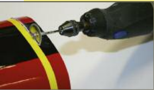
Um größeren Bleilasten im Heck vorzubeugen, wurde der Motor rund 12 mm nach hinten versetzt. Die Motorhaube muss mit einer Diamantscheibe entsprechend gekürzt werden. Ein Dremel-Tool leistet hier gute Arbeit.
